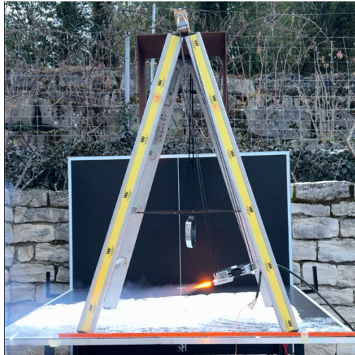
Abbildung 30: Pendel in maximaler Auslenkung mit 4.15kg Pendelmasse und 1m Pendellänge. Resultierte im Überschwingen
