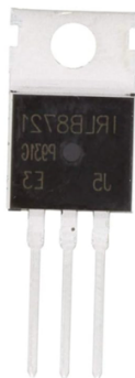
Abbildung 4: Zündschaltung mit N-Channel-MOSFET IRLB8721 (30 V, 62 A), der den Zündstrom eines einzelnen Elektroanzünders aus einem 9-V-Blockakku mittels 3,3-V-Steuersignal des Flugcomputers schaltet.
