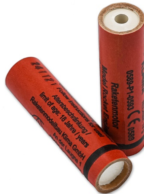
Abbildung 6: Hauptmotor (D9-P) mit 20Ns Totalimpuls und ohne Verzögerung
