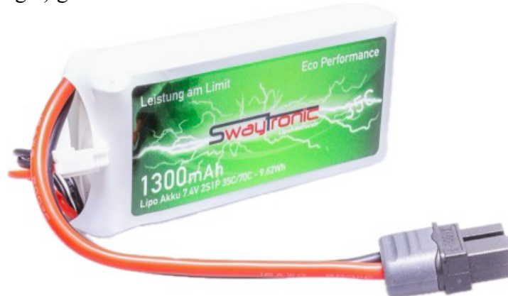
Abbildung 3: 2-s-LiPo-Akku (7,4 V, 1300 mAh) als Hauptstromquelle mit Reserven für zukünftige Zusatzmodule wie Kamera oder GPS
