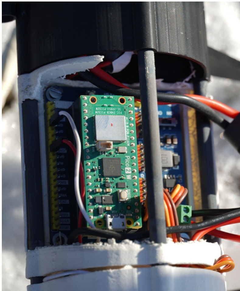
Abbildung 15: Flugcomputer mit Raspberry Pi Pico 2W (grün) im Gehäuse montiert
