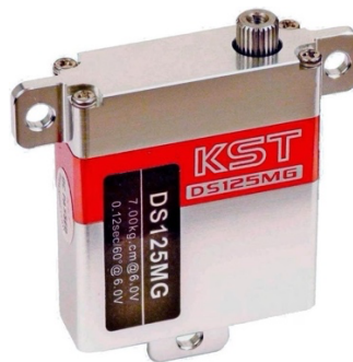
Abbildung 1: KST DS125MG Mini-Servo bei Landeklappen: Die irreführende Herstellerangabe 7 kg/cm entspricht 7 \text{ kgf} \cdot \text{cm} und nach 1 \text{ kgf} \cdot \text{cm} \approx 0.098 \text{ Nm} ergibt dies ein Drehmoment von rund 0.69Nm, welches am Servogelenk wirkt.
